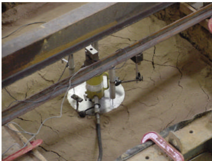
Figura 56 – Detalhe da superfície de ruptura
