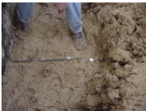
Figura 49 – Linha de células a 10 cm da superfície do solo mole
